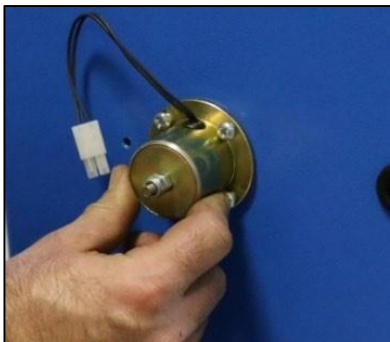
Ilustracja: Elektromagnes na zewnętrznej powierzchni kolumny
